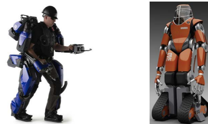
Figuur 4.2 Twee voorbeelden van een 'powerpak' of 'wearable machine'. Links sarcos' guardian xo die nog in ontwikkeling is, rechts MechaMAX by Montgomery Design International.
