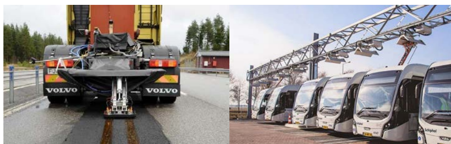
figuur 5 APS techniek voor transport of een pantograaf van Helios
